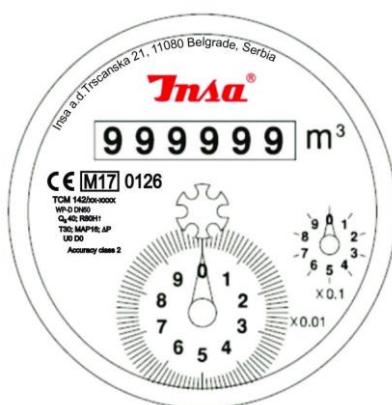
Слика 5. Изглед плоче показног уређаја водомера (6+2)
