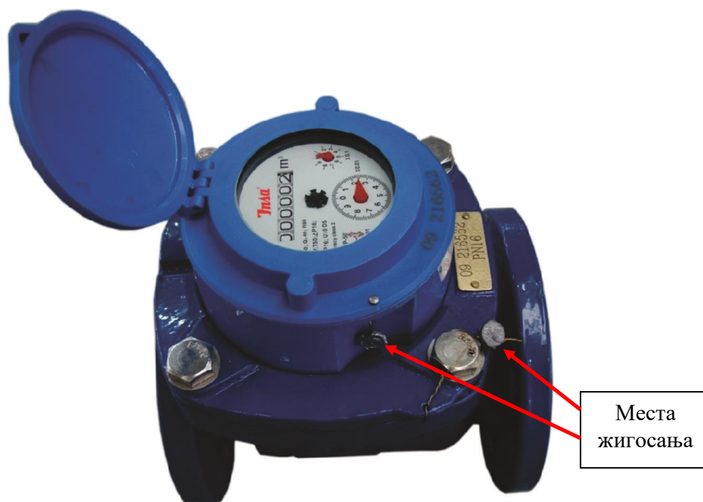
Слика 1. Спољашњи изглед водомера без одвојеног вијка за подешавање и приказ жигосања
