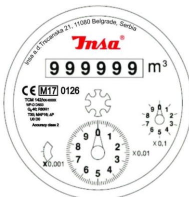
Слика 6. Изглед плоче показног уређаја водомера (6+2+1)
